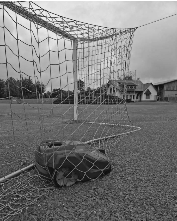
Beschädigung des Tores durch Verfangen des Roboters im Netz
